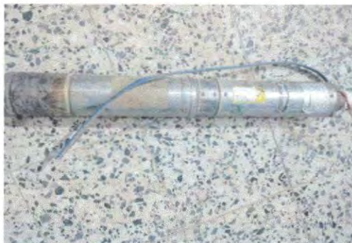
Foto 26: Sustitución de bomba de agua
